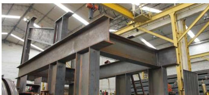
FABRICACIÓN DE ESTRUCTURA CON VIGA COMERCIAL
