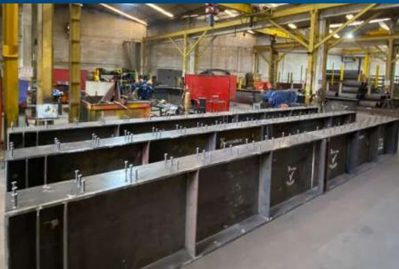
FABRICACIÓN DE VIGAS DE 1000 MM DE ALTURA
