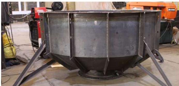
TANQUE HIDROCIKLÓN EN LÁMINA A36
